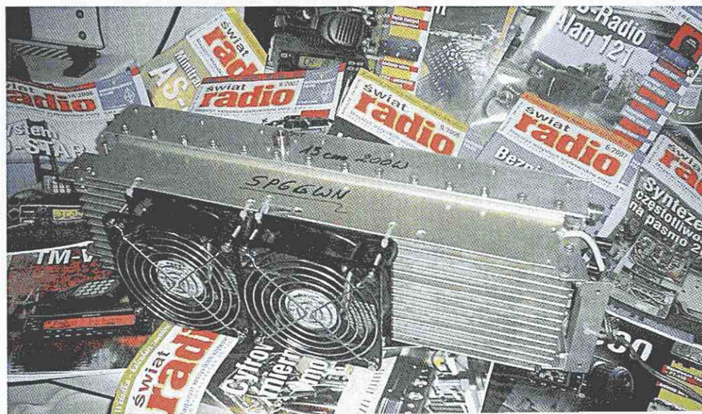
PA 13 cm po modernizacji
