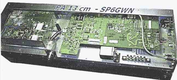
Wzmacniacz na 13 GHz SP6GWN w trakcie montażu (widać PA i przetwornicę z 46 V/28 V)
